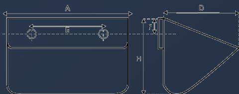
En tôle d'acier extra-forte, emboutie. Le fond et les angles arrondis évitent au contenu de rester dans le godet, même si la matière à élever est humide. A vitesse lente, l'INUSABLE travaille bien tous les grains. Le montage sur la courroie est alors assez espacé. A vitesse rapide, l'INUSABLE travaille non seulement les grains, mais aussi les produits en poudre. Leur montage est plus rapproché.
