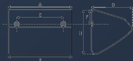
Godet de la vitesse et donc du rendement, son angle jetée comme sa forme arrondie ont été étudiés pour remplir et vider très vite, en continu. Ils se montent sans solution de continuité sur les courroies et sont pourvus de joues canalisant le flot de marchandises élevé dans les conduits des élévateurs. C'est le godet des grands débits par excellence.
