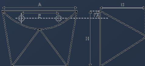
Modèle conique à déversement continu, en forte tôle d'une seule pièce et sans soudure. Ces godets se montent les uns derrière les autres sur la courroie, à se toucher. Le fond angulaire aplati du godet «le RAPIDE» et son angle de projection sont étudiés pour permettre son montage dans des élévateurs classiques. Ils travaillent très bien les produits granuleux secs, le blé et les céréales.
